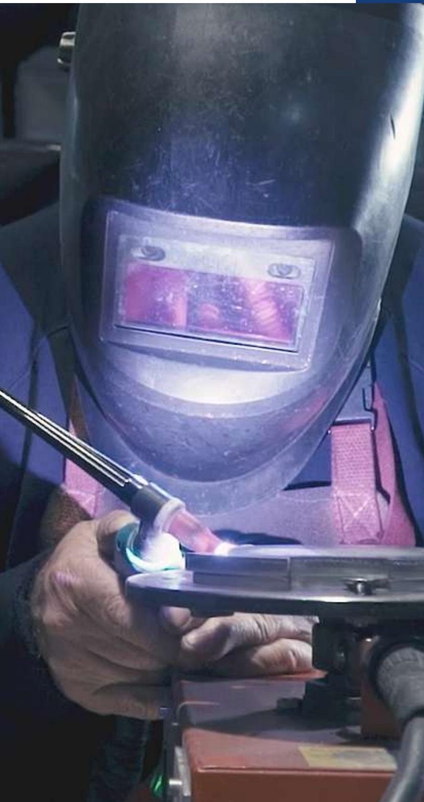
La Saldatura TIG (Tungsten Inert Gas) è un processo di saldatura che sfrutta l'elevata temperatura generata da un arco elettrico stabilitosi tra l'elettrodo infusibile di tungsteno e il pezzo da saldare.
